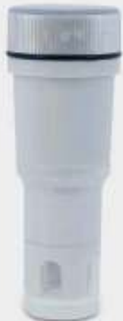
pH electrode Catalog No: 616.01.103
